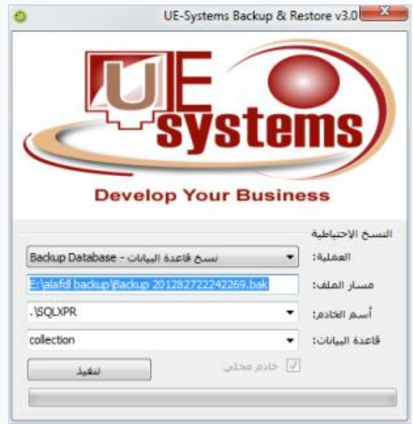
شكل (242): أداة النسخ الاحتياطي والاسترجاع UE-Systems Backup & Restore
